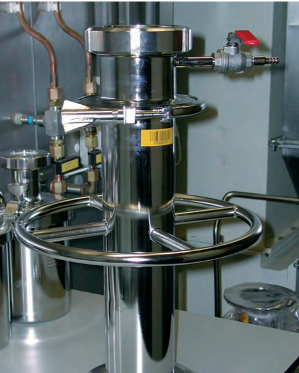
Zylindrisch angepasster EPTS-Behälter und CIP-Kammer
