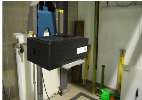
Abb. 14: Kiste, Fallposition "flach auf das Oberteil"
