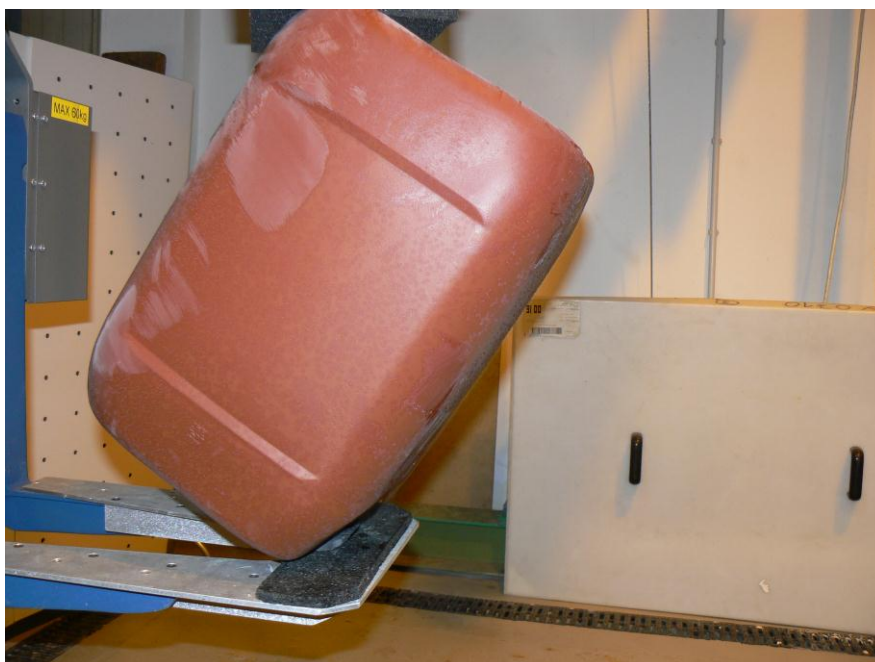
Abb. 12: Kanister diagonal auf Verschluss
