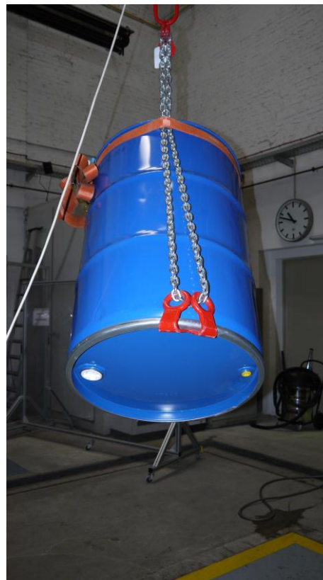
Abb. 6: improvisiertes Anschlagen zur Realisierung der gewünschten Fallposition
