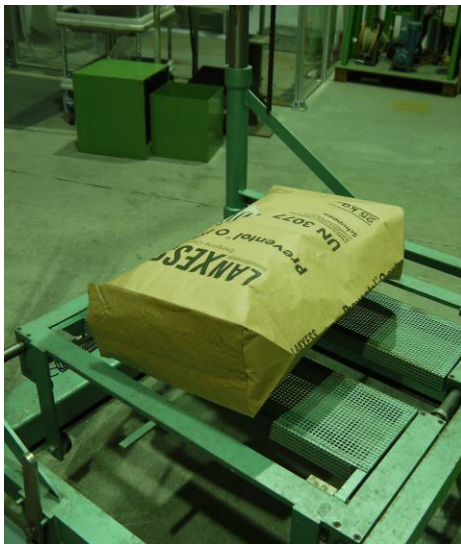
Abb. 18: Fallposition "flach auf die Breitseite"
