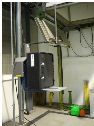
Abb. 16: Kiste, Fallposition "flach auf die kürzeste Seite"
