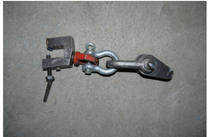
Abb. 2: Krampe zum diagonalen Aufhängen von Fässern
