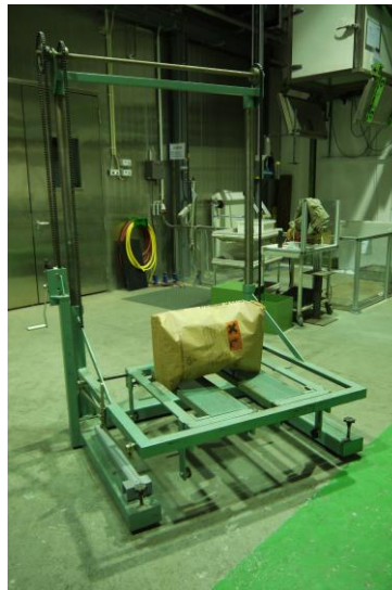
Abb. 19: Fallposition "flach auf die Schmalseite"
