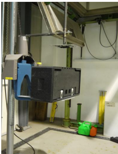
Abb. 15: Kiste, Fallposition "flach auf die längste Seite"
