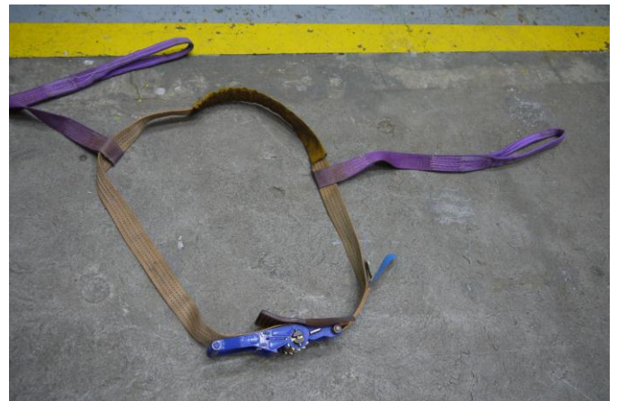
Abb. 4: Gurt zum geraden Heben eines Fasses
