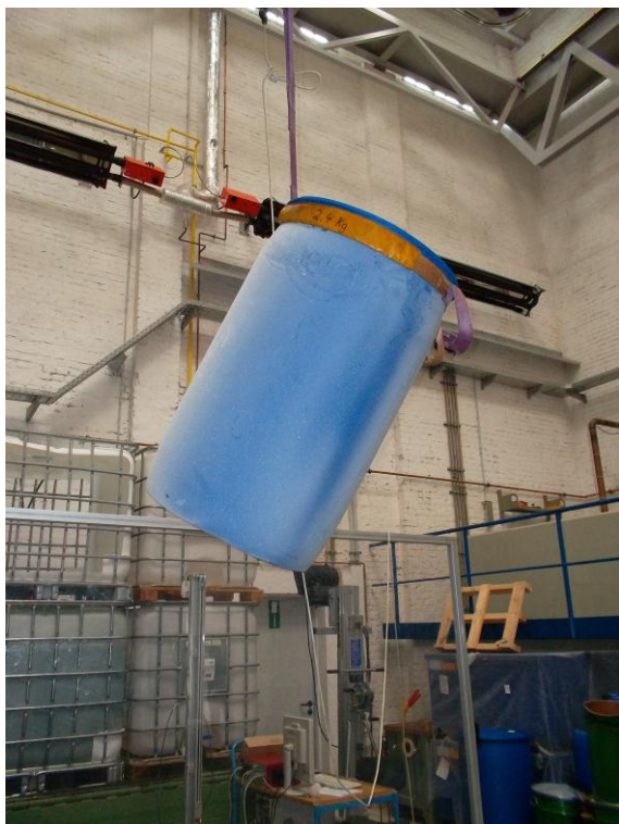
Abb. 10: Fass diagonal auf Bodenkante
