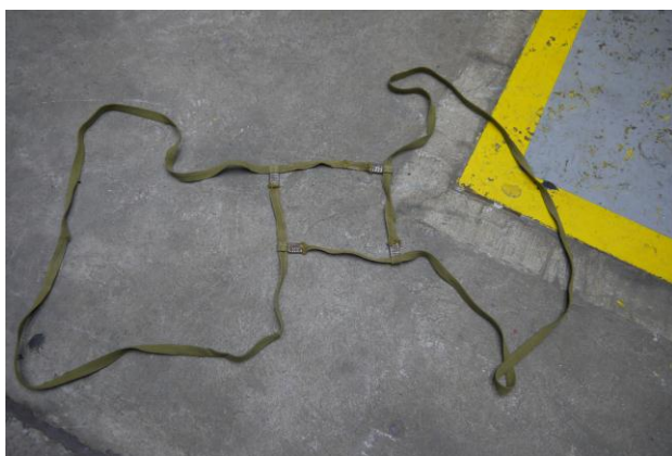
Abb. 7: einmaschiges Netz zum variablen Aufhängen verschiedener Verpackungen. Die Masche ist größenverstellbar. Dieser Gurt ist dünn/schmal genug, um (bei mittelgroßen Verpackungen) keinen signifikanten Einfluss auf das Auftreffen auf dem Fundament auszuüben
