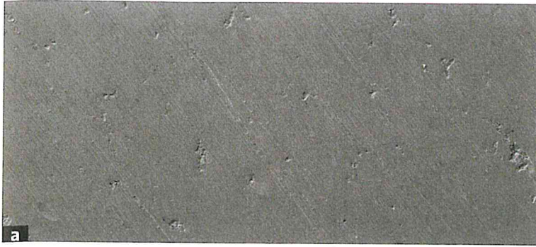
REM-Aufnahmen behandelter Edelstahl-Oberflächen, a) gebürstet, b) gebürstet und elektropoliert, c) OGF und elektropoliert Bilder: Bolz Intec
